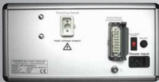
Anschlüsse für SPS-Steuerung
